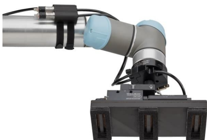
Aangepaste vacuümgrijper met in spuitstuk gemonteerde venturi vacuümpomp, .24 kg
